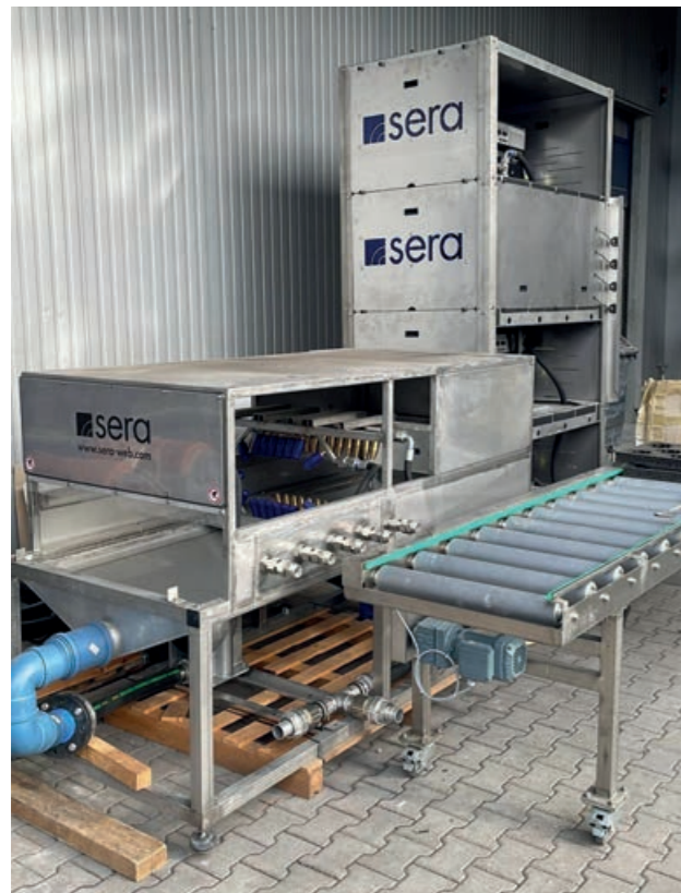
Kundenspezifische Durchlaufanlage zur Reinigung von Sonderprofilen zur Pulverbeschichtung.
