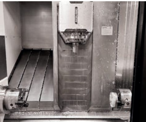
Spindeleinheit zur axialen und radialen Bearbeitung.
