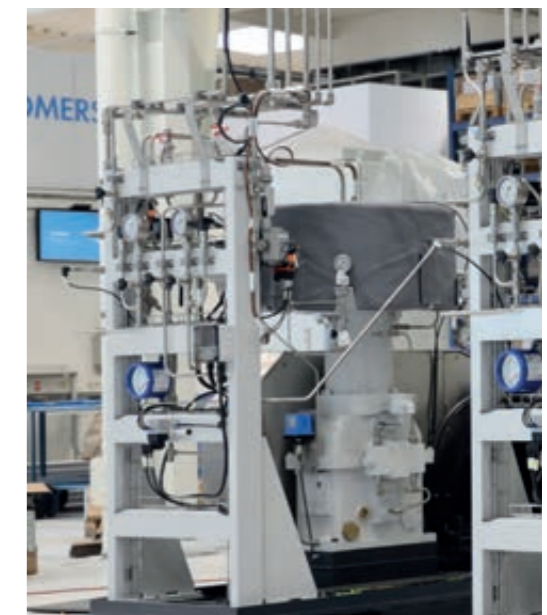
Einer von drei Metallmembrankompressoren der PU-Serie: Präzise, kontaminationsfrei und gebaut für höchste Reinheit.
