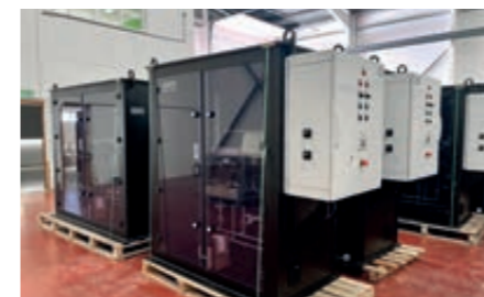
sera lieferte 14 Dosiersysteme mit insgesamt 40 Membrandosierpumpen, ausgestattet mit Schaltschränken und Profibus-DP-Kommunikation.
