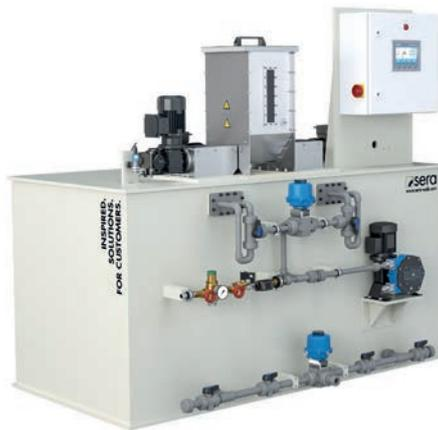
El contenedor del sistema oscilante consta de 2 cámaras separadas. La solución de polímero se prepara sucesivamente en las cámaras. Después de un tiempo de maduración definido, la solución de polímero se puede extraer. Queda excluido el remanente del producto.
