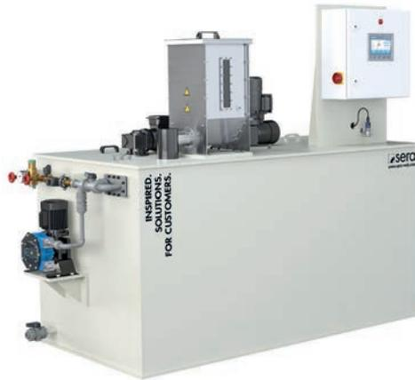
En el sistema de 3 cámaras, el polímero se disuelve en agua en la primera cámara. En la segunda cámara, el polímero madura. A través del rebosadero, la solución acabada llega a la tercera cámara, de donde se extrae. Mediante un proceso adaptado de forma óptima a la tarea, se minimiza el remanente del producto.
