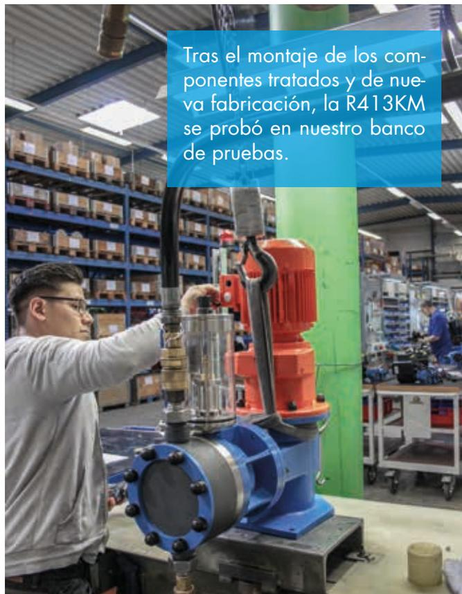
Tras el montaje de los componentes tratados y de nueva fabricación, la R413KM se probó en nuestro banco de pruebas.
