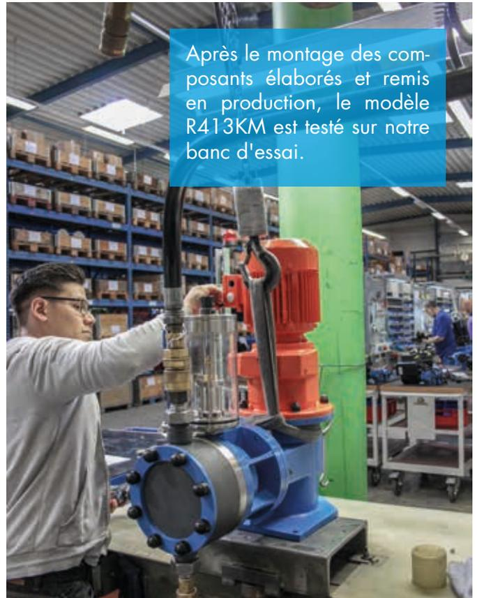
Après le montage des composants élaborés et remis en production, le modèle R413KM est testé sur notre banc d'essai.
