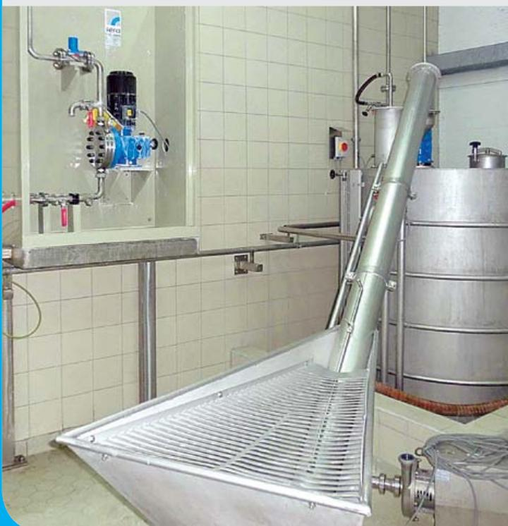
**sera** Umfüllanlage und Vorlagebehälter für die fertige Lösung
