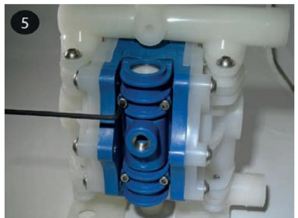
**AUSTAUSCH DES KOMPLETTEN LUFTSTEUERVENTILS**
