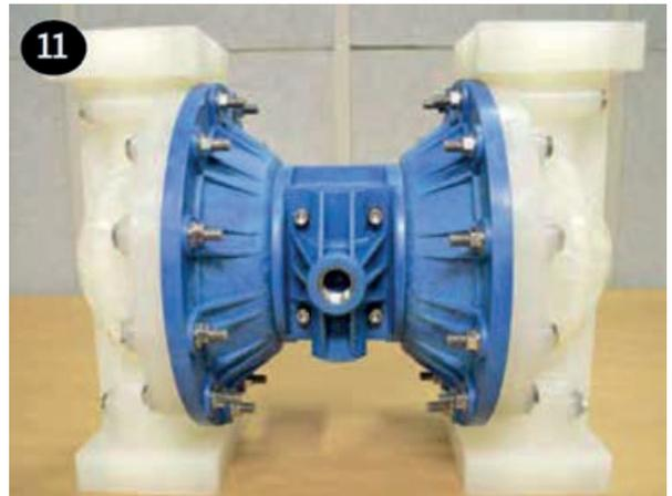
**Hinweis:** Beim Einbau von PTFE Membranen ist es wichtig, dass beide äußeren Membranteller gleichzeitig angezogen werden. Dies gewährleistet einen sicheren Sitz.
