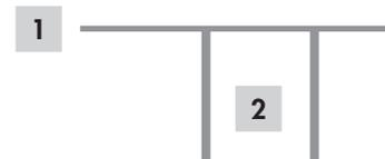
Stichleitungen sind grundsätzlich für Übertragungsgeschwindigkeiten größer 1.5 Mbit/s nicht erlaubt. Bei Übertragungsgeschwindigkeiten kleiner gleich 1.5 Mbit/s dürfen Stichleitungen eingesetzt werden, wenn sie die in der Tabelle angegebenen Grenzen nicht überschreiten.
