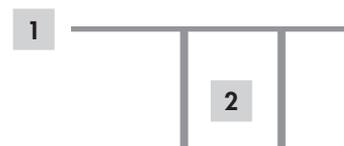
En general, las derivaciones no están permitidas con velocidades de transmisión superiores a 1,5 Mbit/s. Con velocidades de transmisión inferiores o iguales a 1,5 Mbit/s se admiten las derivaciones siempre que no se excedan los límites indicados en la tabla.
