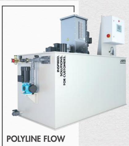
Bei der 3-Kammer-Anlage wird das Polymer in der ersten Kammer mit Wasser gelöst. In der zweiten Kammer reift das Produkt. Über den Überlauf gelangt die fertige Lösung in die dritte Kammer, aus der die Entnahme erfolgt. Durch einen optimal auf die Aufgabe abgestimmten Ablauf wird die Produktverschleppung minimiert.
