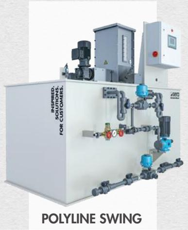
Der Behälter der Pendel-Anlage besteht aus zwei getrennten Kammern. In den Kammern erfolgt nacheinander der Ansatz der Polymerlösung. Nach einer definierten Reifezeit steht die Polymerlösung zur Entnahme bereit. Eine Produktverschleppung ist ausgeschlossen.
