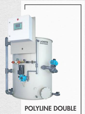
Bei der Doppelstock-Variante sind die Kammern übereinander angeordnet. Der Ansatz des Polymers erfolgt in der oberen Kammer. Nach Ablauf der Reifezeit wird das fertig gereifte Produkt in die untere Kammer abgelassen. Durch den Ablauf wird eine Produktverschleppung verhindert.
