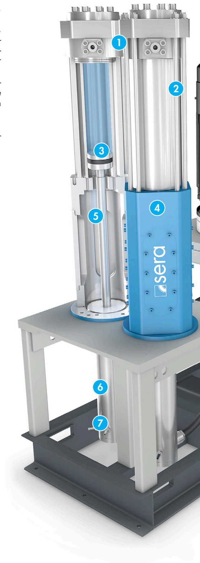
Die elektrohydrostatisch angetriebenen trockenlaufenden Kolbenkompressoren von **sera** verdichten völlig schmiermittellos partikelfreie Gase wie Wasserstoff, Stickstoff, Helium, Argon oder Ethylen. Durch die spezielle Anordnung und Ausgestaltung der Gaskolbendichtungen und Führungselemente ist es auch bei Hoch- und Höchstdruckanwendungen möglich, auf die sonst übliche Schmierung der Dichtungskomponenten komplett zu verzichten.
