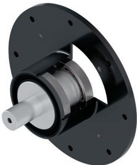
Die Montage der Lagerbox im Pumpengehäuse garantiert perfekte Ausrichtung, sowie komplette Absorption der Kräfte an der Welle. Die Lagerbox unterstützt die verstärkten und überdimensionierten Lager und die Pumpenwelle, wodurch ein kompakter und sehr robuster Aufbau möglich ist. Dies garantiert unschlagbare Robustheit und Kraft der Pumpe, auch unter schwierigsten Bedingungen im Dauerbetrieb mit Drücken bis zu 10bar. Minimale Wartungskosten und Stillstandszeiten.
