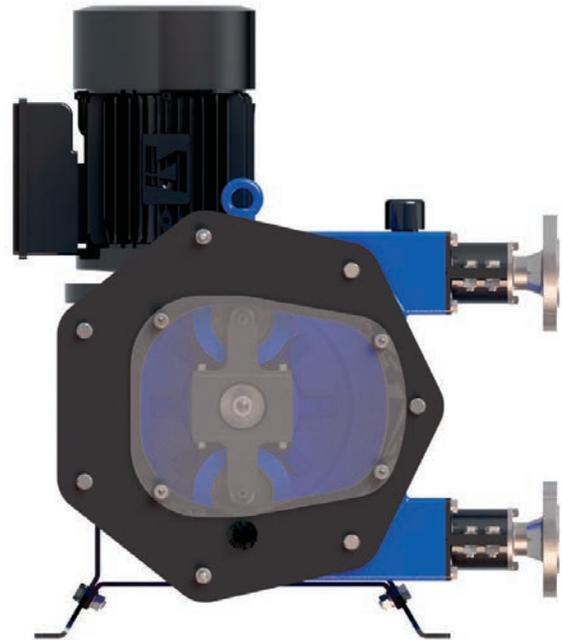
Die Robustheit der I28 und I35 Pumpen basiert auf zwei Lagern, welche die axialen Kräfte zwischen Rotor und Getriebe absorbieren, dem Rotorzusammenbau und XXL Rollen mit maximaler Performance. Ein innovatives Design sowie ein kompaktes und einfaches Montagesystem runden die Baureihe ab.
