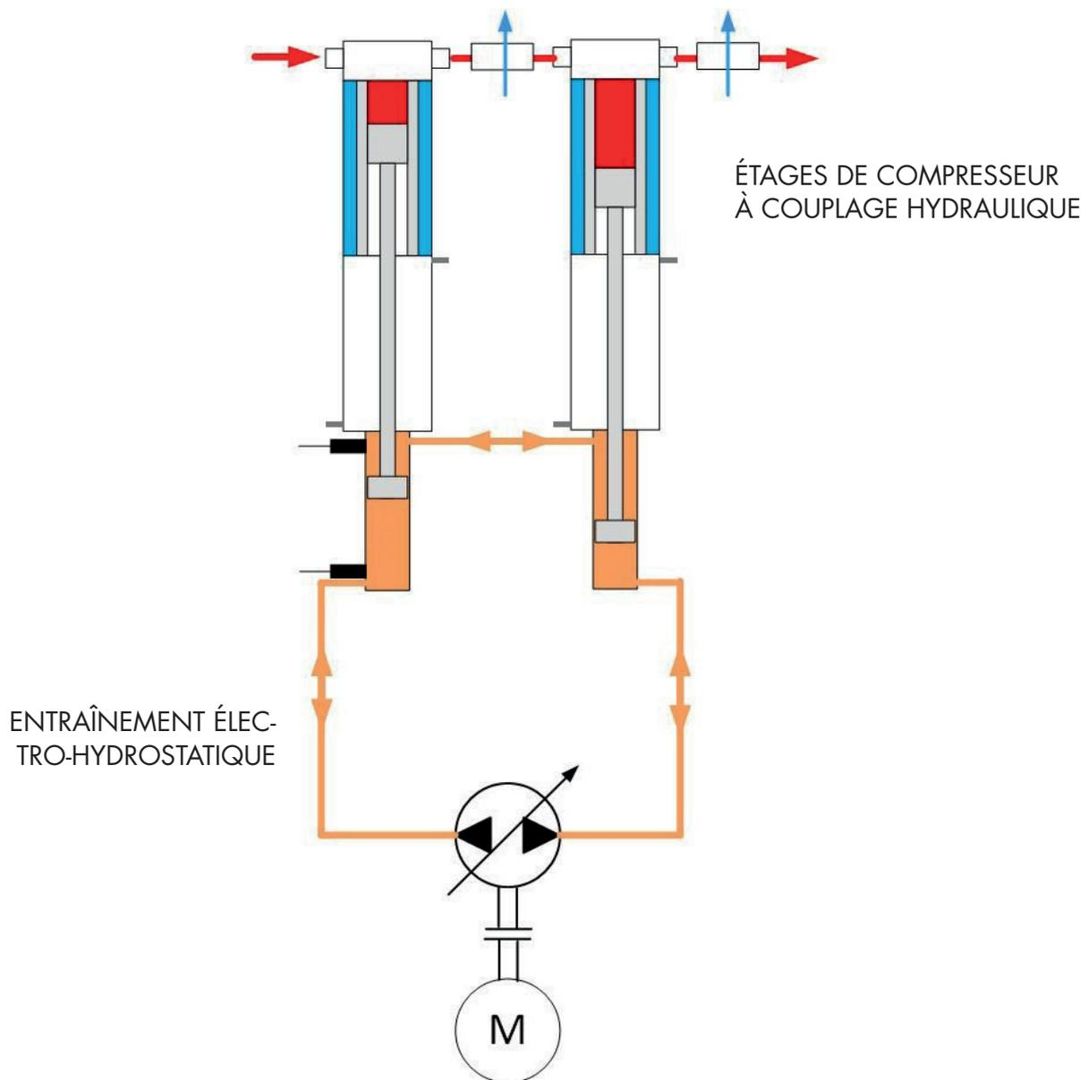
Le groupe de compression se compose de deux vérins à gaz coaxiaux verticaux, chacun étant relié mécaniquement à un vérin hydraulique et entraîné par celui-ci.
